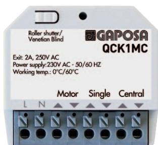
È un modulo per il comando centralizzato di più motori con una logica di funzionamento che dà la priorità al comando centralizzato rispetto al comando individuale e, nel comando centralizzato, al senso della SALITA piuttosto che a quello della DISCESA. In questa configurazione è possibile utilizzare per il comando individuale anche gli interruttori salita/discesa e collegare all'ingresso del comando centralizzato una centrale che gestisce la sicurezza vento.
