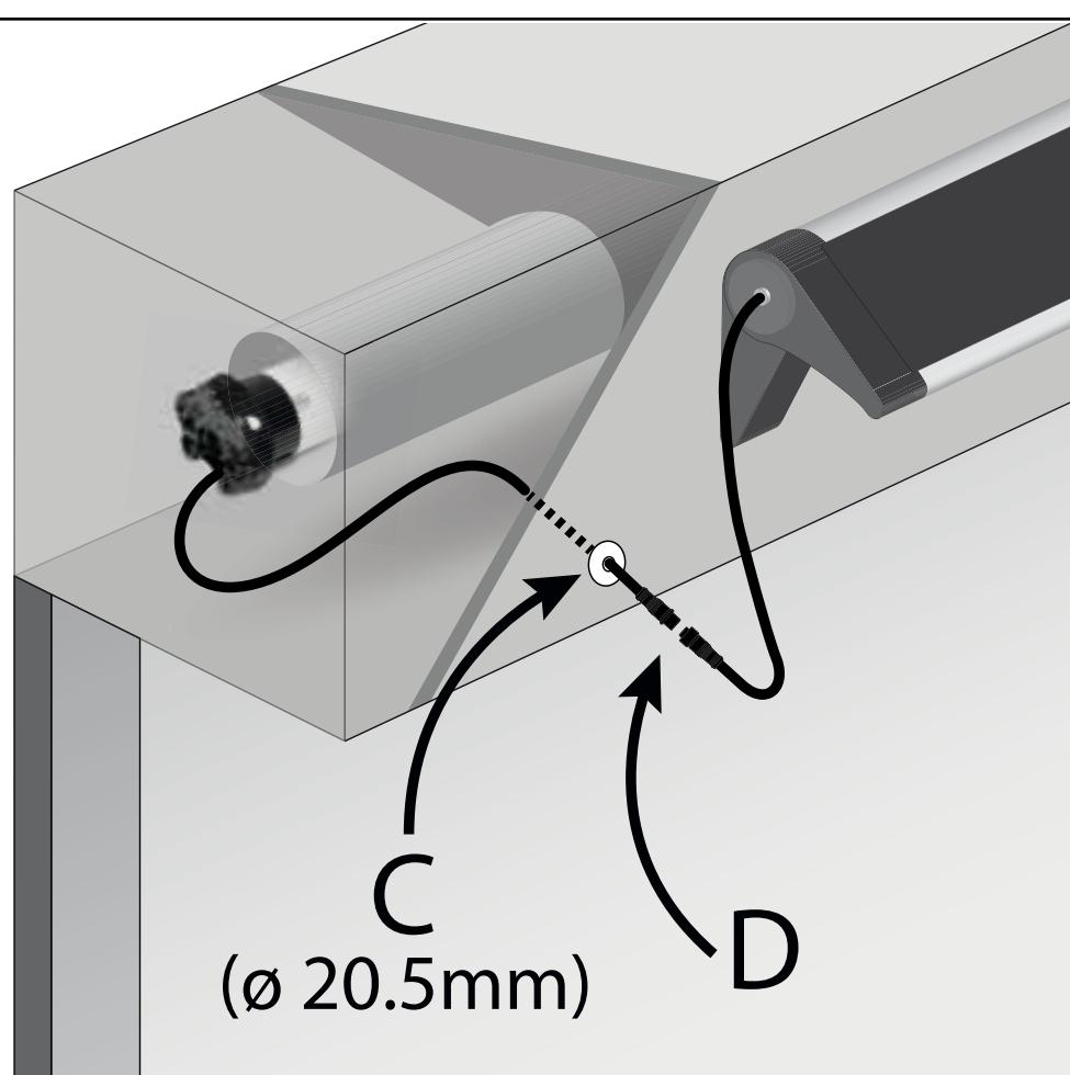
Le câble du moteur est équipé d'un presse-étoupe (C) qui peut être monté sur une tôle d'une épaisseur de 0,5 à 3 mm en percant un trou de Ø 20,5 mm.
