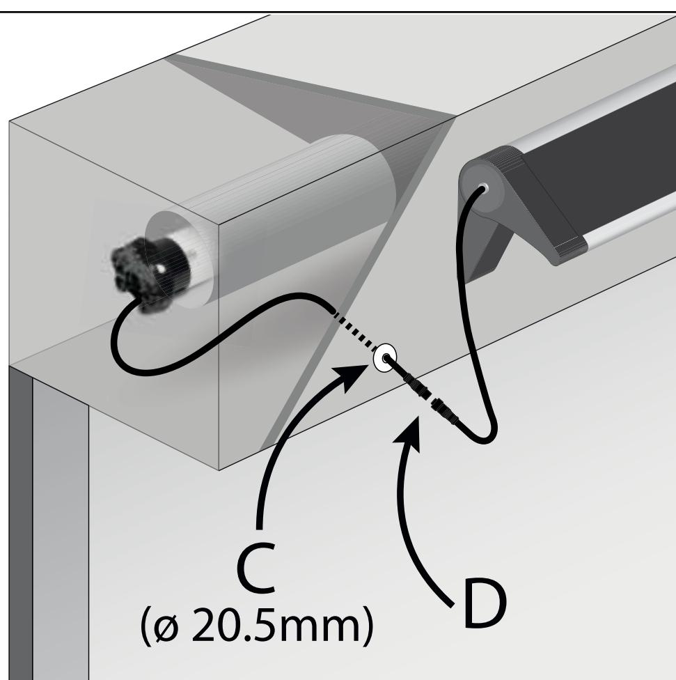
El cable del motor está equipado con un prensaestopas (C) que puede montarse en chapa metálica de 0,5 a 3 mm de grosor taladrando un agujero de Ø 20,5 mm.
