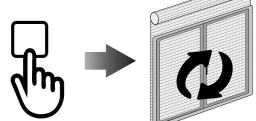
Nota: El ajuste fino de los finales de carrera se puede lograr en SUBIDA o en BAJADA pulsando el botón PROG-FC una segunda vez: el motor se moverá lentamente por pequeños movimientos hasta la posición deseada. Pulsar siempre el botón STOP para guardar la posición.
