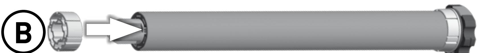
**2** Insérez le motoréducteur **E** dans le tube **F** jusqu'à ce que l'extrémité de cela soit sur la butée de la bague du fin de course.
