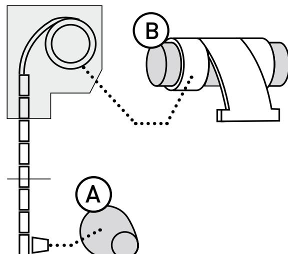
Appuyer et maintenir le bouton MONTEE plus de 2 secondes et relâcher. Le moteur montera et s'arrêtera en butée pour fixer sa fin de course haute.
