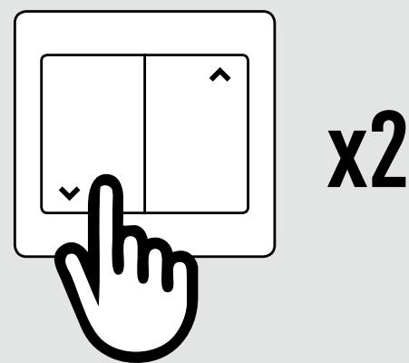
**3** Appuyez et maintenez le bouton bas jusqu'à ce que le moteur effectue un va et vient. Le moteur est maintenant en mode programmation
