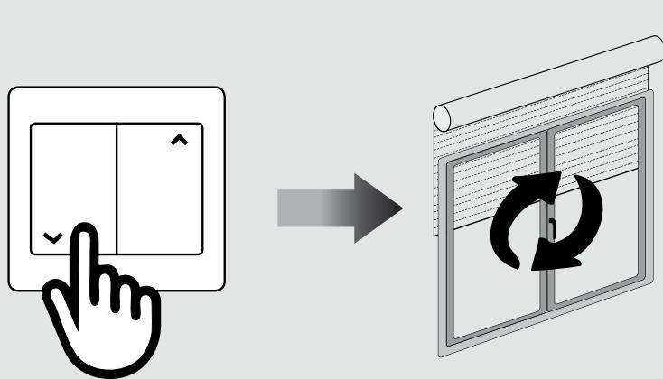
**Le moteur sense signale qu'il est en mode programmation en faisant une courte pause d'une seconde pendant son fonctionnement.**
