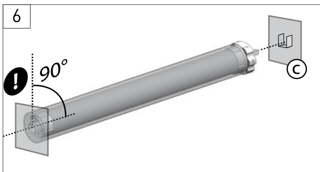
Placez le moteur sur le support (C) et l'extrémité opposée du tube sur la plaque de fixation. Ne jamais frapper sur la tête du moteur lorsque vous l'insérez dans le tube.
