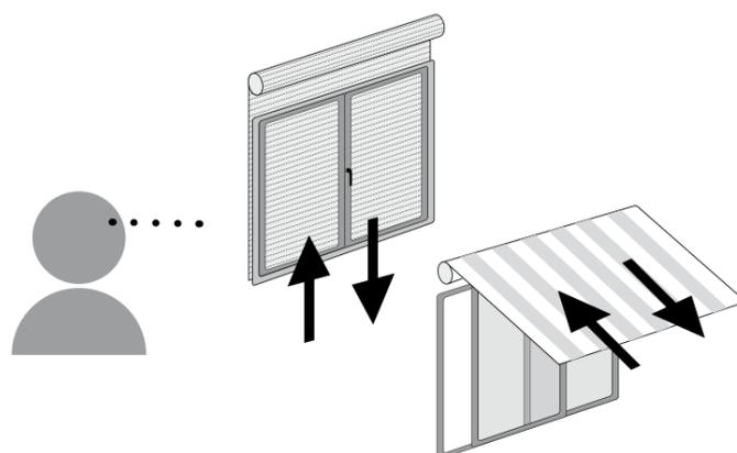
**4** Premere entro 5 secondi il tasto SALITA o DISCESA (a seconda del movimento del motore).
