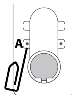
**3** Controllate il senso di rotazione del motore, rilasciate PROG-TX (il motore si ferma).
