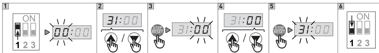
1. Posizionare il DIP1 del selettore (S3) su ON, il campo PARAMETRO inizierà a lampeggiare
