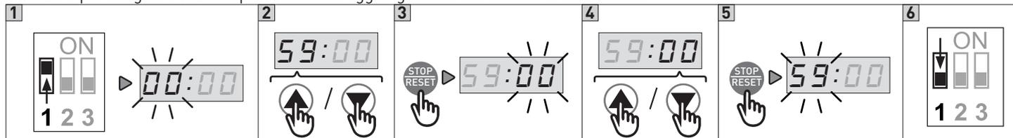
1. Posizionare il DIP1 del selettore (S3) su ON, il campo PARAMETRO inizierà a lampeggiare
