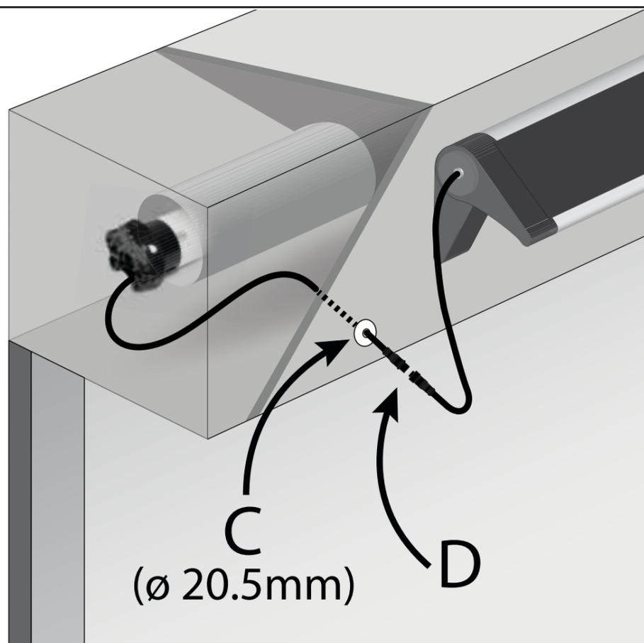
Le câble du moteur est équipé d'un presse-étoupe (C) qui peut être monté sur une tôle d'une épaisseur de 0,5 à 3 mm en perçant un trou de  $\varnothing 20,5$  mm.
