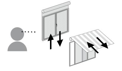
Premere entro 5 secondi il tasto SALITA o DISCESA (a seconda del movimento del motore) del **trasmettitore da aggiungere**. In questo modo il nuovo trasmettitore è stato memorizzato e sincronizzato con il senso di rotazione del motore.
