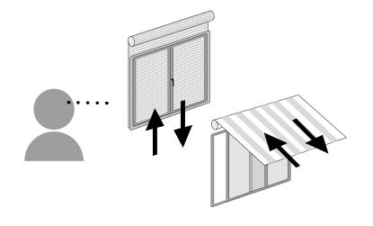
Premere entro 5 secondi il tasto SALITA o DISCESA (a seconda del movimento del motore). In questo modo il trasmettitore è stato memorizzato e sincronizzato con il senso di rotazione del motore.
