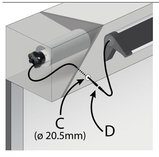
Il cavo del motore è fornito di passacavo (C) che può essere montato su lamiere con spessore da 0,5 a 3 mm, realizzando un foro ø 20.5 mm.
