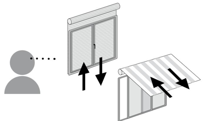
**4** Antes que pasen 5 segundos pulsar la tecla correspondiente (SUBIDA si la rotación del motor era de subida o BAJADA si viceversa). Se ha realizado la memorización del emisor y se ha sincronizado el sentido de rotación del motor.
