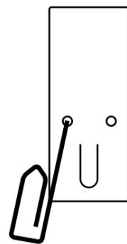
**3** Controlar el sentido del motor y soltar el botón PROG-TX (el motor se para).
