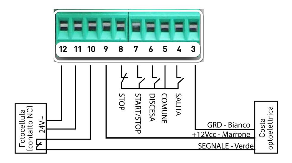
Per collegare la fotocellula, quest'ultima va connessa ai morsetti 11-12 (24V) e 9-10 (**DIP 4 in OFF**).
