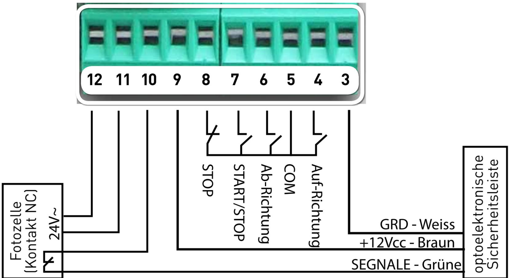
Die Fotozelle muss angeschlossen werden wie gezeigt (**DIP 4 OFF**).
