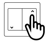
Wenn der Motor nach oben läuft, halten Sie die AB-Taste gedrückt, bis Sie 2 kurze Bewegung als Bestätigung der Aktivierung erhalten.
