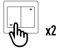
Drücken und halten Sie die AB-Taste zum dritten Mal, bis der Motor eine kleine Bewegung in beide Richtungen macht.
