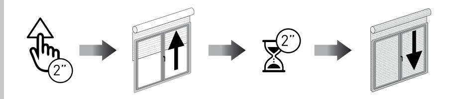
Führen Sie zur Uberprüfung einen vollständigen TOP/BOTTOM-Zyklus des Rollladens durch
