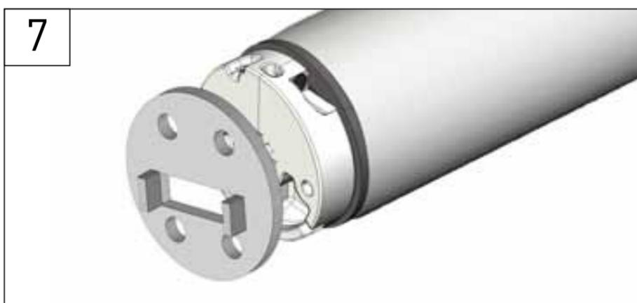
Atornille la placa del soporte en la cabeza del motor
