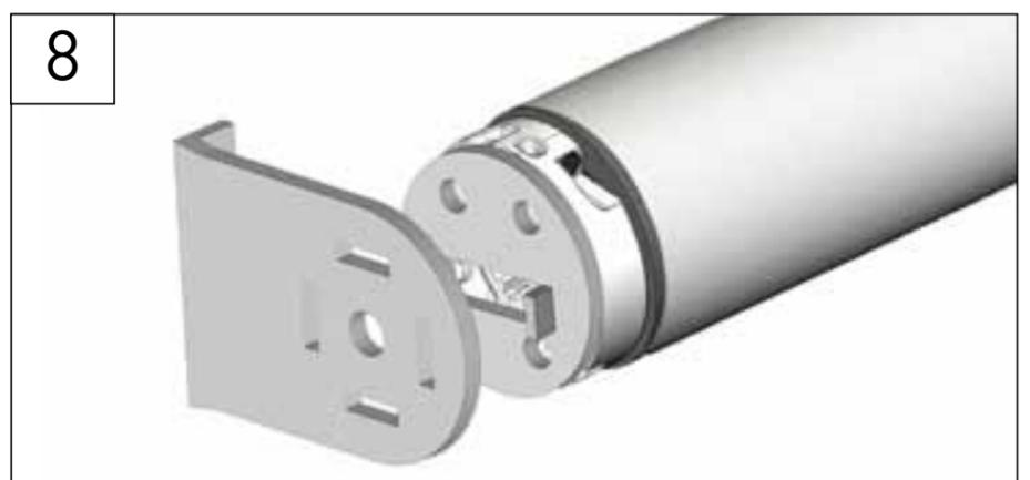
Coloque el tubo motorizado en sus soportes
