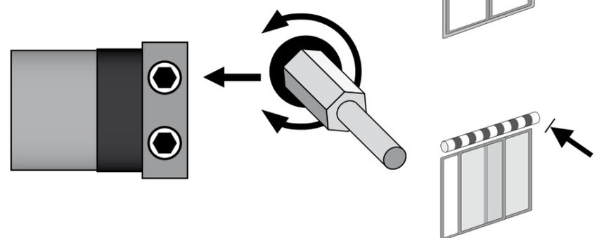
**Um den oberen Endschalter zu korrigieren, wenn nötig, den Motor kurz abwärts laufen lassen, dann die obere Schraube Richtung **-** drehen.
